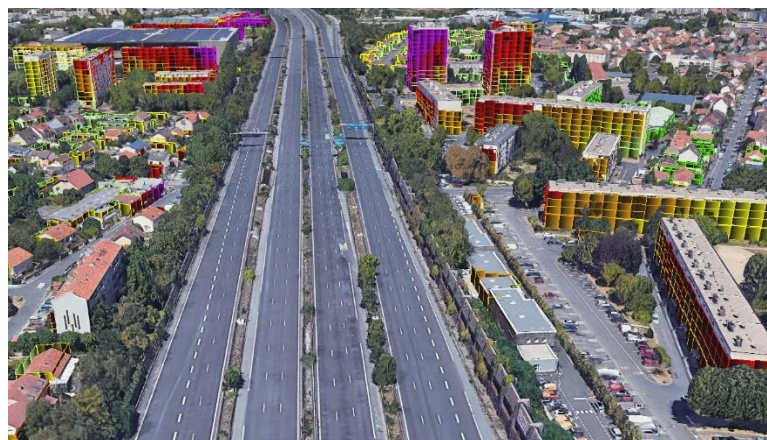
Cartographie du niveau sonore (Lden) en façade des bâtiments un an après la pose du revêtement antibruit (2018)
