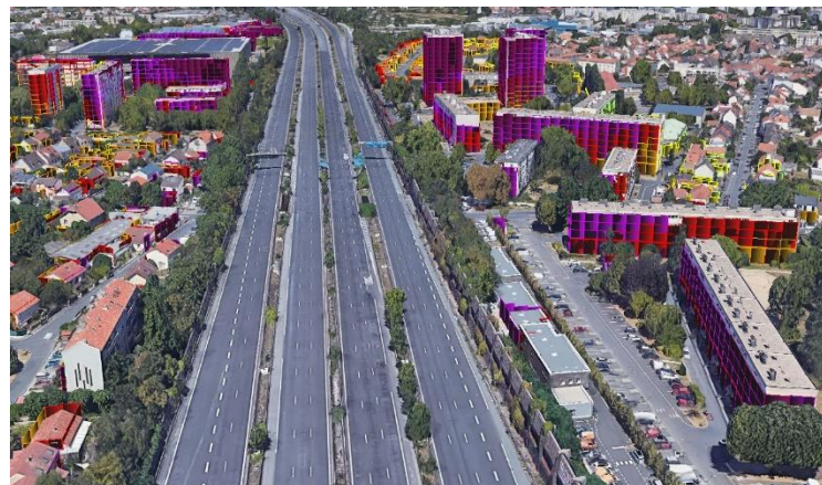
Cartographie du niveau sonore (Lden) en façade des bâtiments avant la pose du revêtement antibruit
